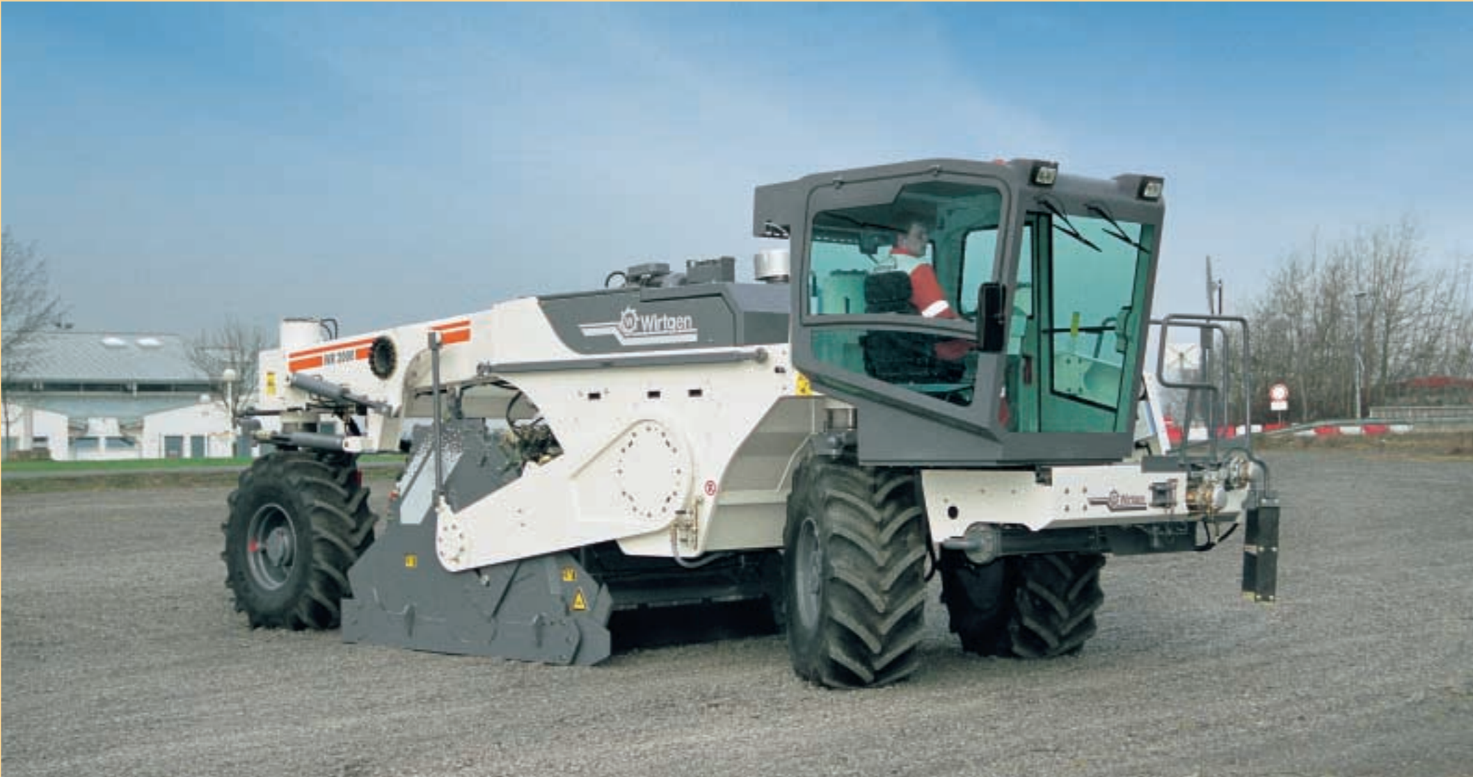
La sterzata delle ruote anteriori avviene tramite il volante e le ruote posteriori vengono sterzate automaticamente secondo il metodo di sterzata impostato. Durante la sterzata a granchio e nel modo „Coordinate“, le ruote posteriori vengono mantenute automaticamente in una posizione rettilinea.
